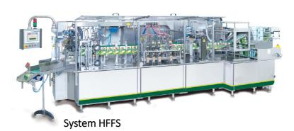
zur Herstellung, Befüllung und Verschließen von Beuteln ab der flachen Folien
