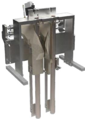
Schnelles und einfaches Umrüsten ist eine der Stärken des PRIMARIS Systems. Formatsätze mit integrierten Siegelwerkzeugen (optional) ermöglichen einen schnellen Wechsel zwischen unterschiedlichsten Beutelformen ohne lange Wiederanlaufzeiten.
